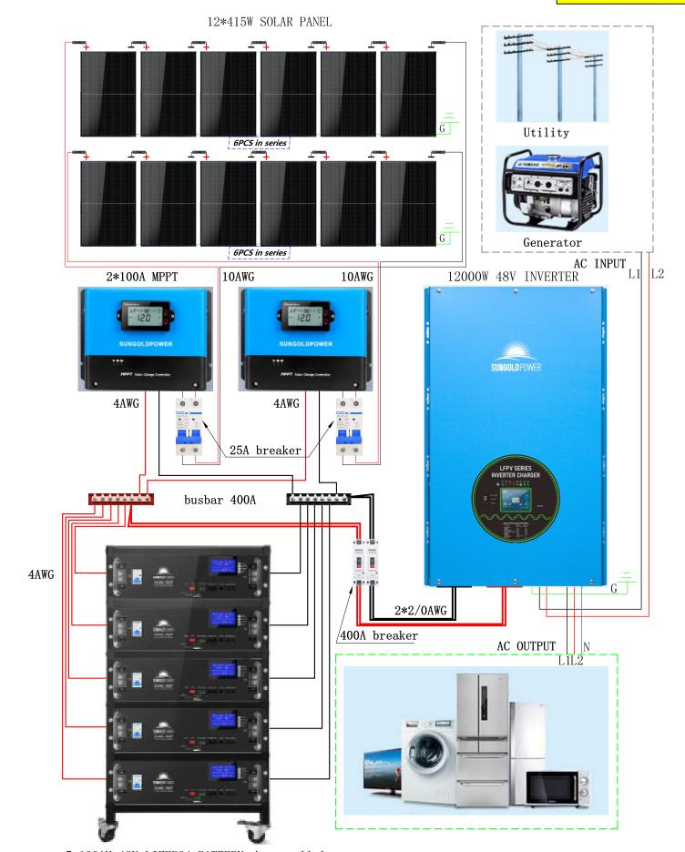
5\*100AH 48V LIFEPO4 BATTERY <u>in parallel</u>
