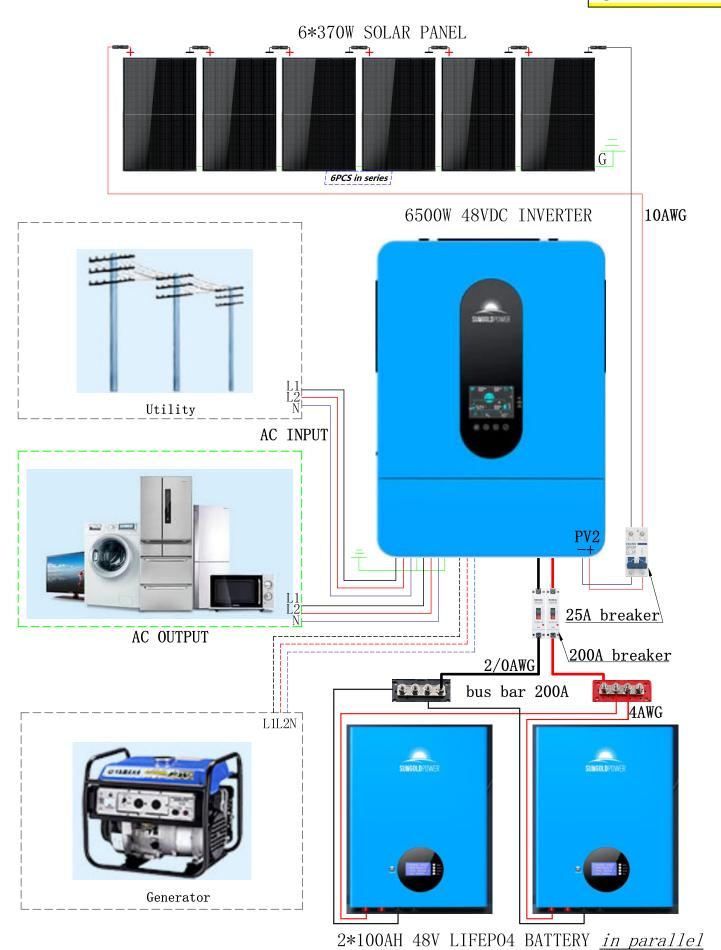
OFF-GRID SOLAR KIT 6500W 48VDC 120/240VAC 10.24KWH POWERWALL LITHIUM BATTERY 6 X 370 WATTS SOLAR PANELS
